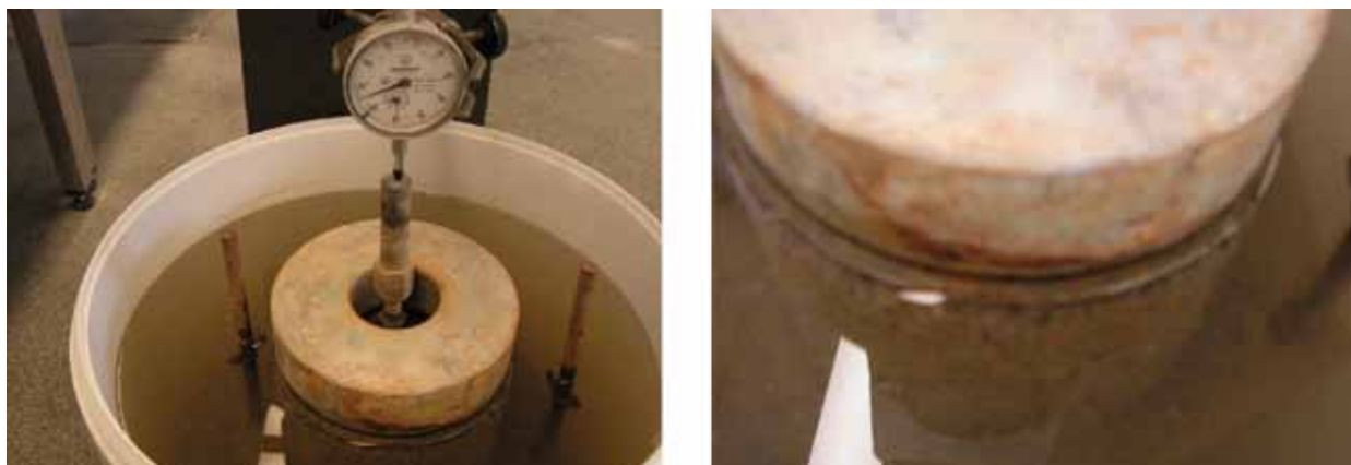
Figura 14. Disposición de ensayo de solubilidad sobre muestra compactada.
