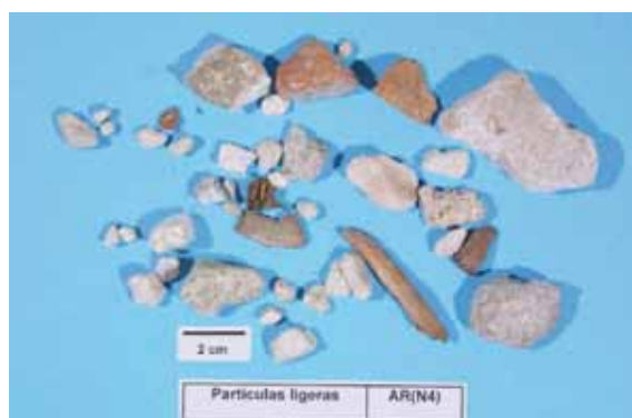
Figura 20. Partículas ligeras procedentes del árido reciclado mixto.
